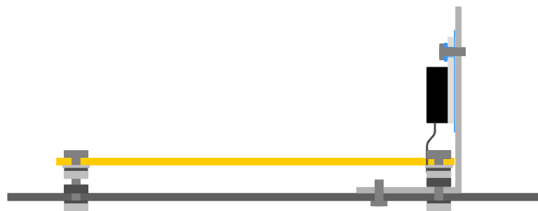
Fig 2: Opstelling voor gebruik van bodemplaat als koelmedium
