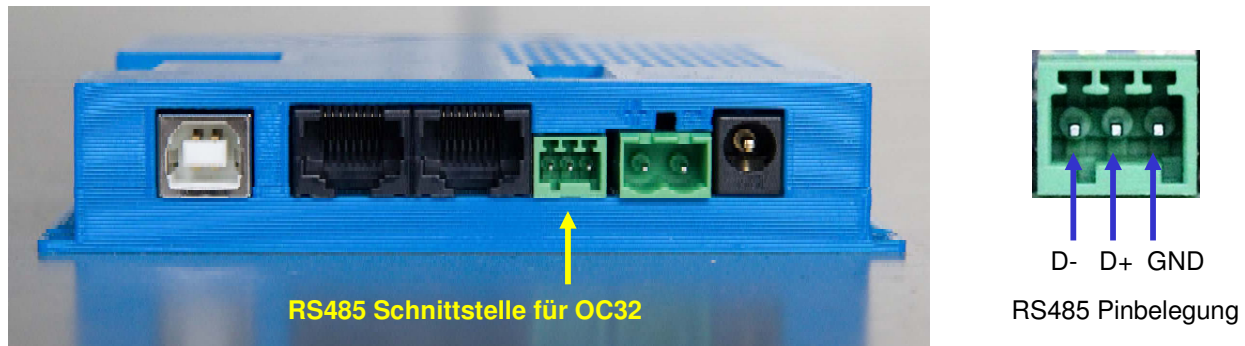
Abbildung 8: RS485-Anschluss für OC32 (altes Modell)
