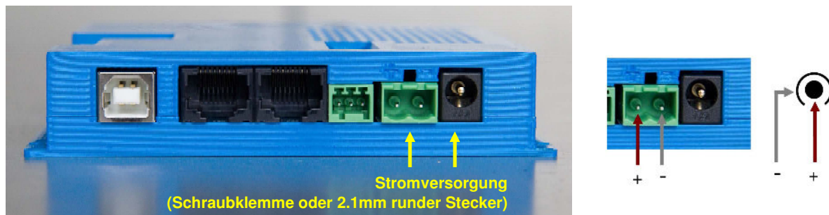
Abbildung 4 Spannungsanschlüsse am UCCI/E(-s)
