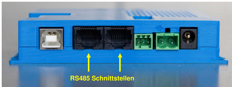
Abbildung 6: RS485-Netzwerkverbindungen zu UCCI/E
