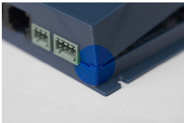
Fig 4: Sluiten van de behuizing
