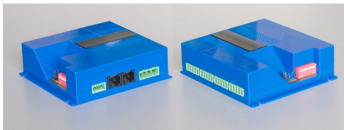
Fig. 8 : TM44 dans son boîtier, avant et arrière
