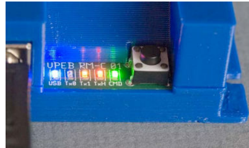
Fig 19: RM-C Reset knop naast de LEDs
