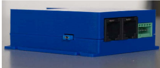
Fig 12: Clockbus terminator jumper aan de zijkant van de RM-C/2 behuizing
