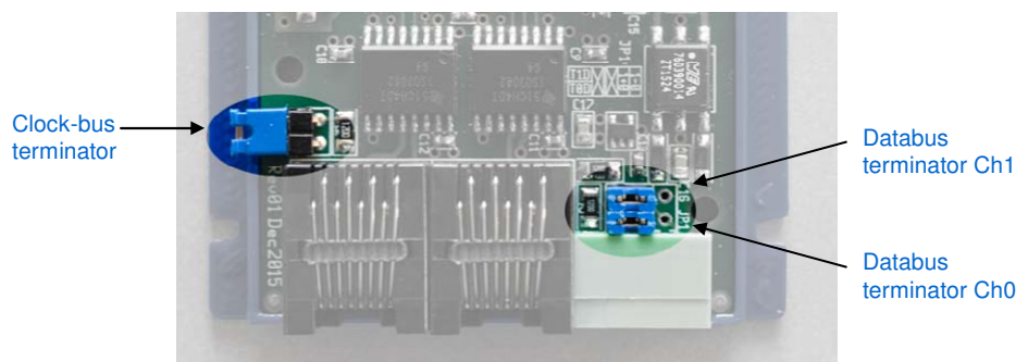
Fig 11: Jumper instellingen bij de RM-C/2
