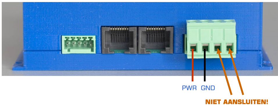
Fig 13: Aansluiten voeding op TM44
