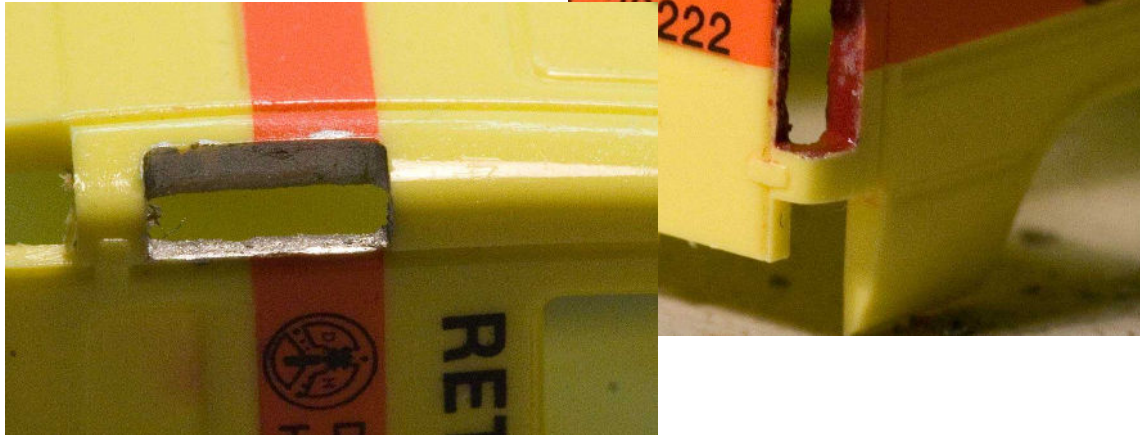
Foto 3 en 4: De binnenzijde van de achterlichten wordt afgedekt met verf om doorschijnen in de kap te voorkomen en het achterlicht weer een roodachtig uiterlijk te geven.
